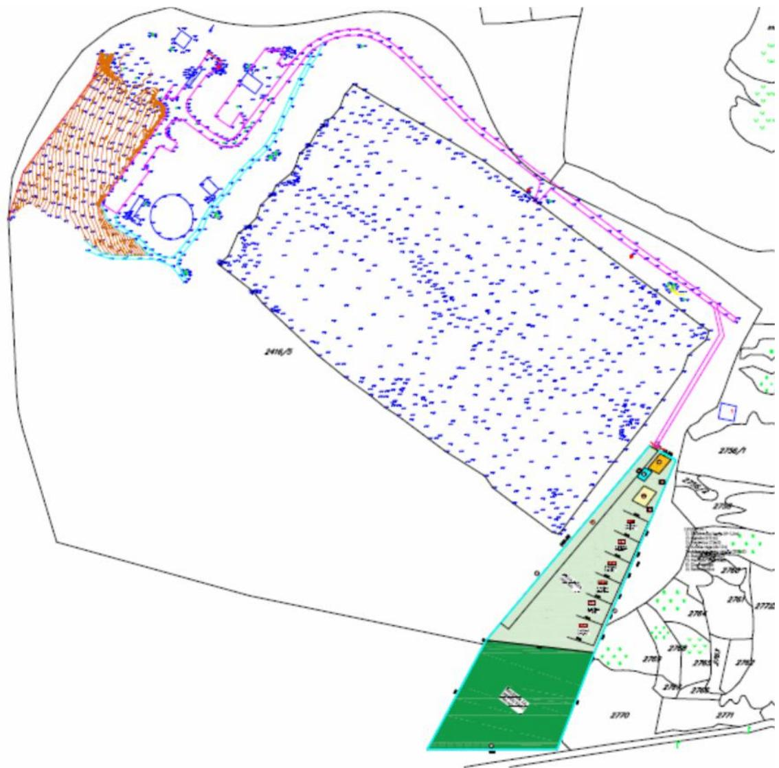
**Slika 30.** Prikaz površine predmetne lokacije za Fazu I i Fazu II, u okviru prostora Sanitarne deponije „Možura” u Baru i saobra ajnicom za vozila sa otpadnim auto gumama do prijema za skladištenje–lagerovanje
